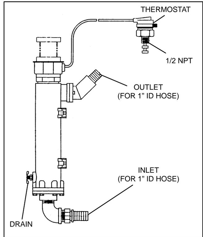
FIGURE 5-5. COOLANT HEATER
