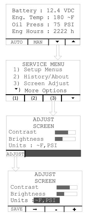
FIGURE 21. BRIGHTNESS AND CONTRAST SCREEN NAVIGATION
