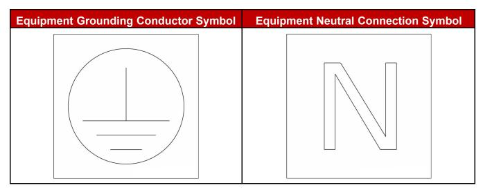
FIGURE 6. SYMBOLS ON CIRCUIT BREAKER BOX
