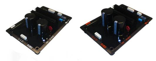
Figure 66: EM10 Excitation Module & EM15 Excitation Module
